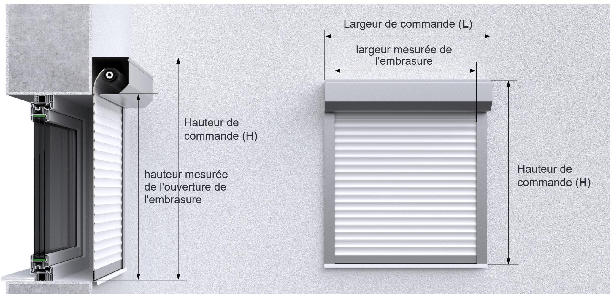
Le caisson de volet roulant est monté sur le mur au-dessus de l'ouverture de la fenêtre, les rails de guidage à gauche et à droite.
